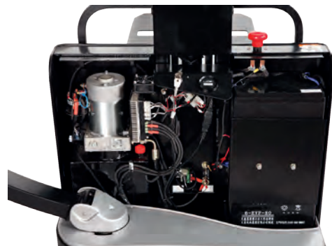
Inbyggd laddare och underhållsfria batterier
