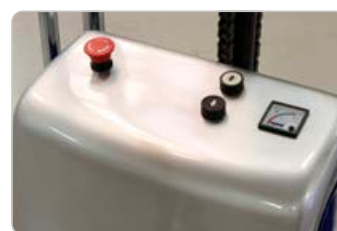
Betjeningspanel med nødstop og batteriindikator
