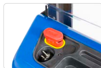
Betjeningspanel med nødstop
