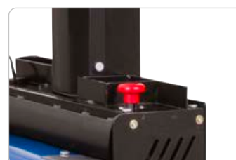
Betjeningspanel med nødstop og batteriindikator
